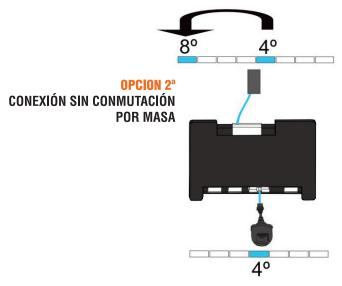
DESCONEXIONES DE ANTINIEBLA DEL VEHICULO: Caso de conmutar los dos antiniebla será necesario que tanto el instalador como el usuario comprueben la coincidencia entre la base de enchufe y las conexiones del remolque. Dado que el dispositivo realiza una conmutación de las cargas hay que comprobar la compatibilidad y asegurarse que durante esta no se producen avisos de avería en el vehículo.
